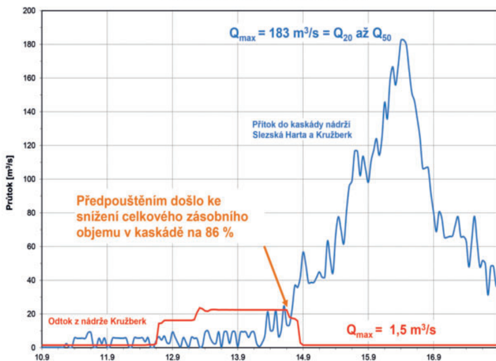
Tlumení povodňové vlny ze září 2024 kaskádou nádrží Slezská Harta a Kružberk na řece Moravici
