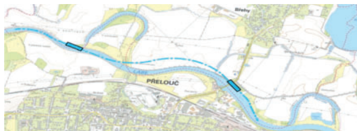
Dílčí záměr C1 – schématické znázornění plavební dráhy (modrá čerchovaná čára) a umístění plavebních komor. Zdroj: Splavnění Labe do Pardubic, Koncepce dle zákona č. 100/2001 Sb., 2023
