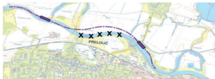
Dílčí záměr C3 – schématické znázornění plavební dráhy (fialová čerchovaná čára), umístění plavebních komor a úseku řeky Labe „ke zrušení“. Zdroj: Splavnění Labe do Pardubic, Koncepce dle zákona č. 100/2001 Sb., 2023
