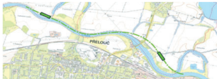
Dílčí záměr C2 – schématické znázornění plavební dráhy (zelená čerchovaná čára) a umístění plavebních komor. Zdroj: Splavnění Labe do Pardubic, Koncepce dle zákona č. 100/2001 Sb., 2023
